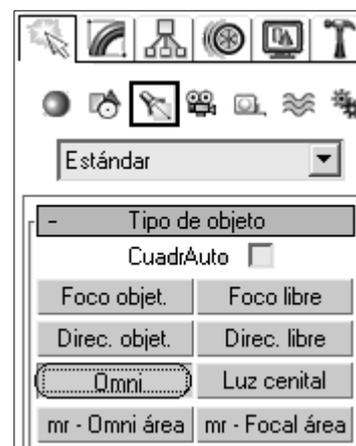
*"Una luz omnidireccional emite rayos en todas las direcciones desde una fuente única"*
